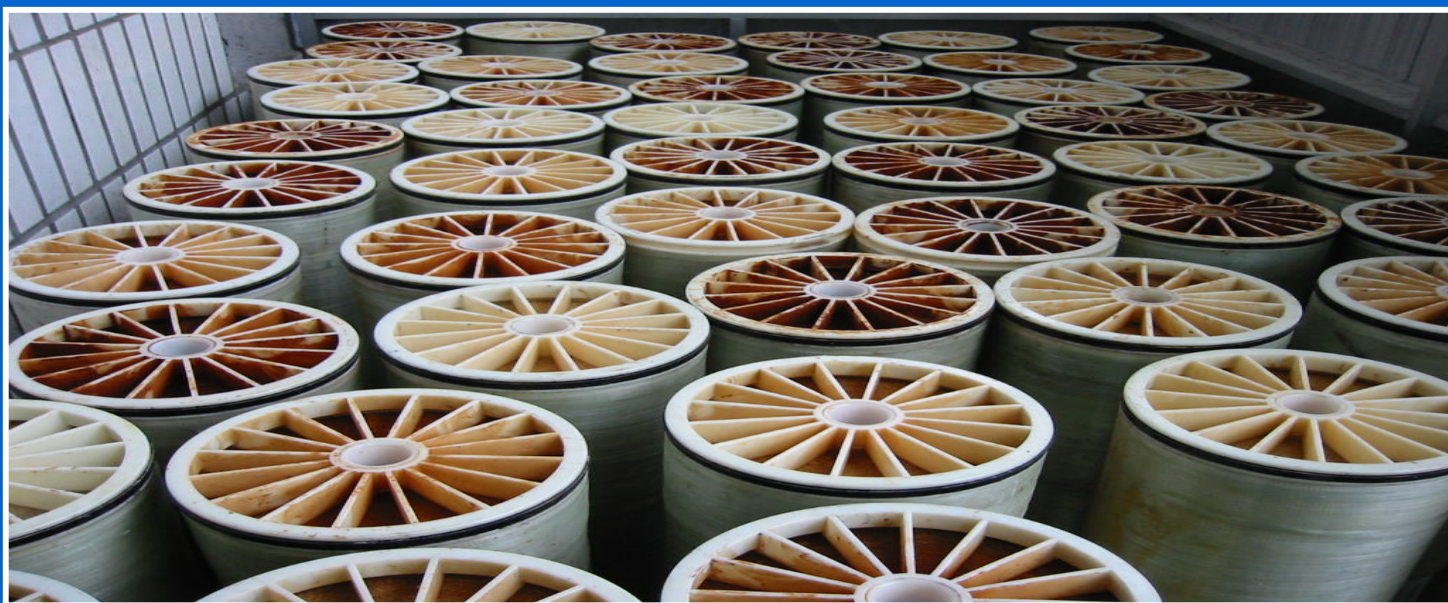
聚丙烯酸铁污染过的RO膜
