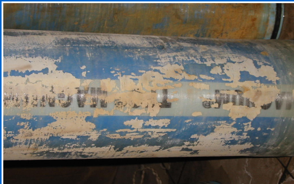
碳酸钙、硫酸钙垢附着在膜表面的情形
