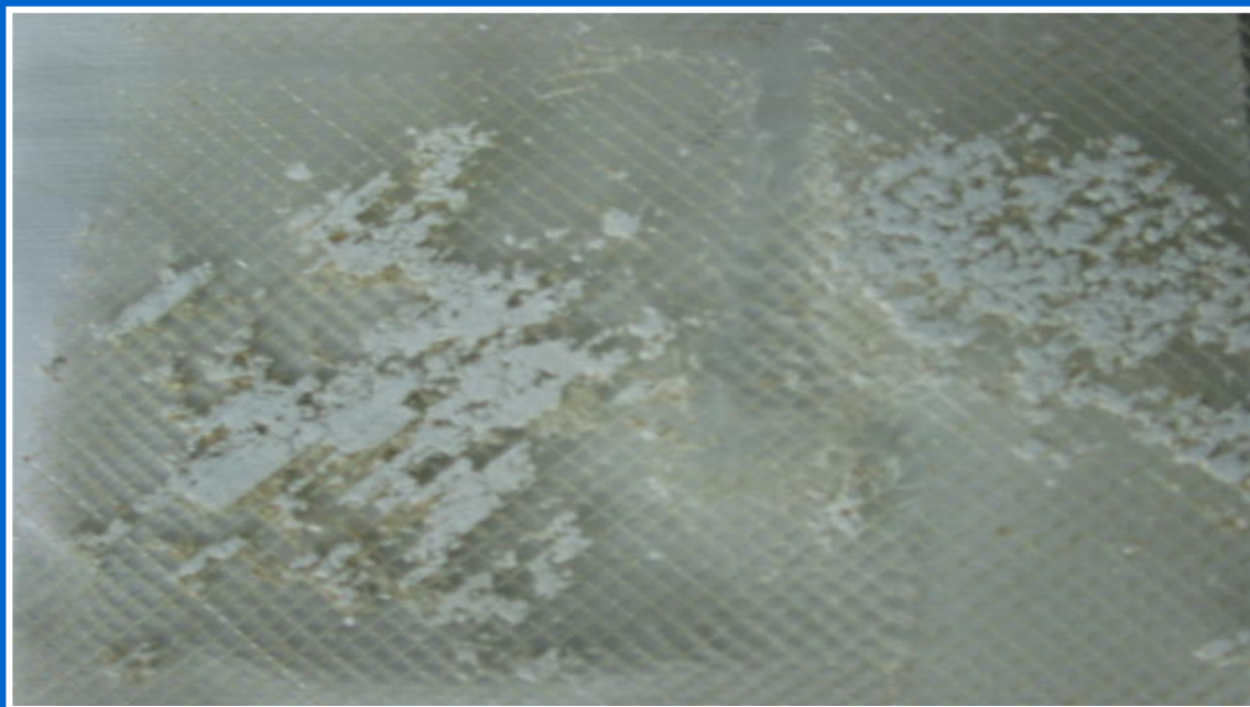
膜隔网上的硫酸钙垢（药液浸泡过）
