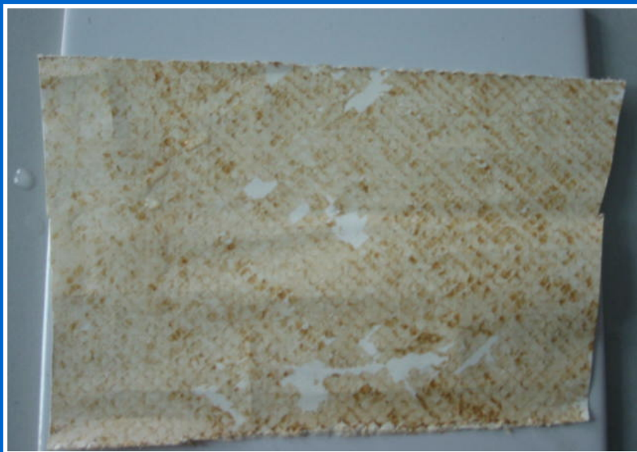
被有机物污染的反渗透膜切片
