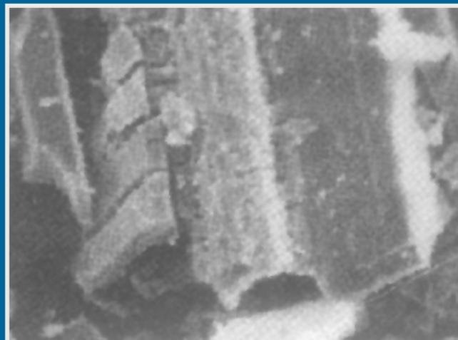
投加 3.5ppmKY-160 的硫酸钙晶体形貌
