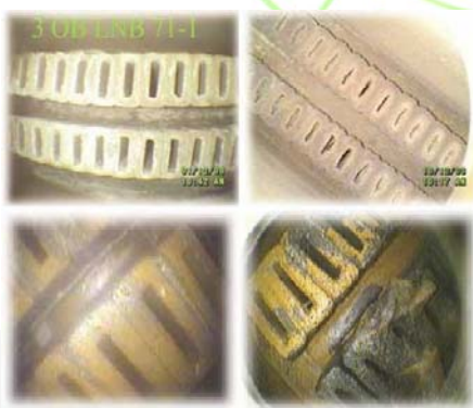
图1 发电机铜导线腐蚀前后图
